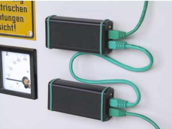
Abb. 3: Ein einziges Datenkabel reicht aus, um Sensoren über ein Bussystem zu verbinden.
